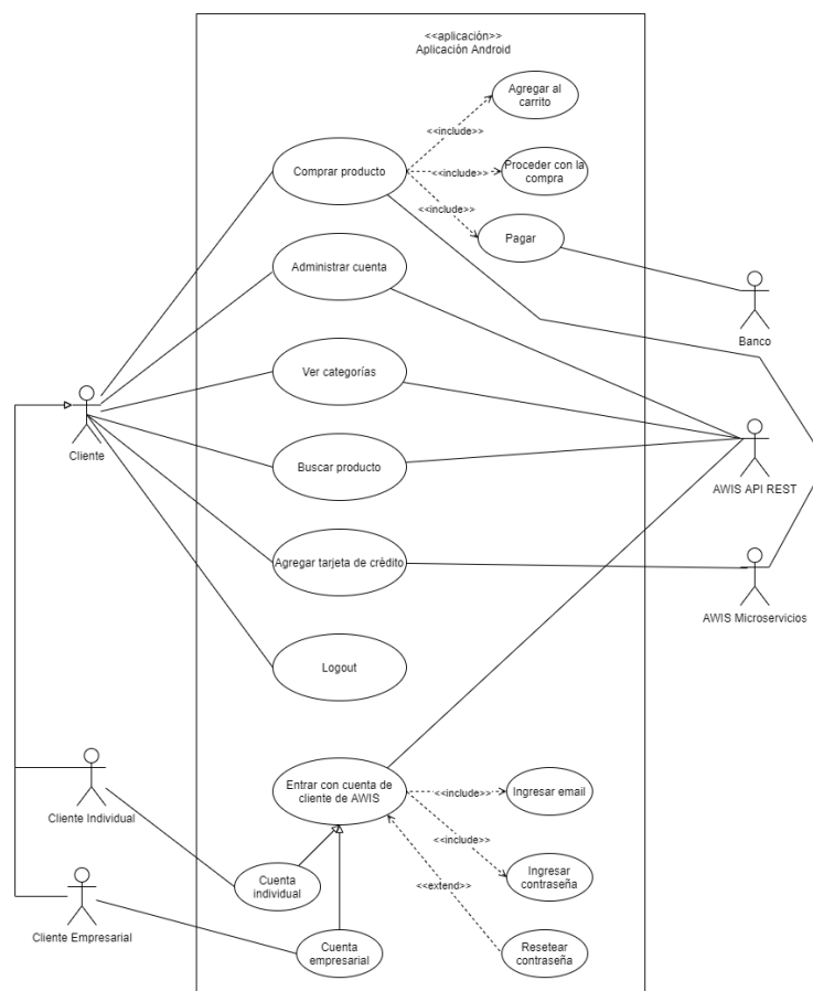
Figura 1: Diagrama UML de Caso de Uso Acceso Principal
